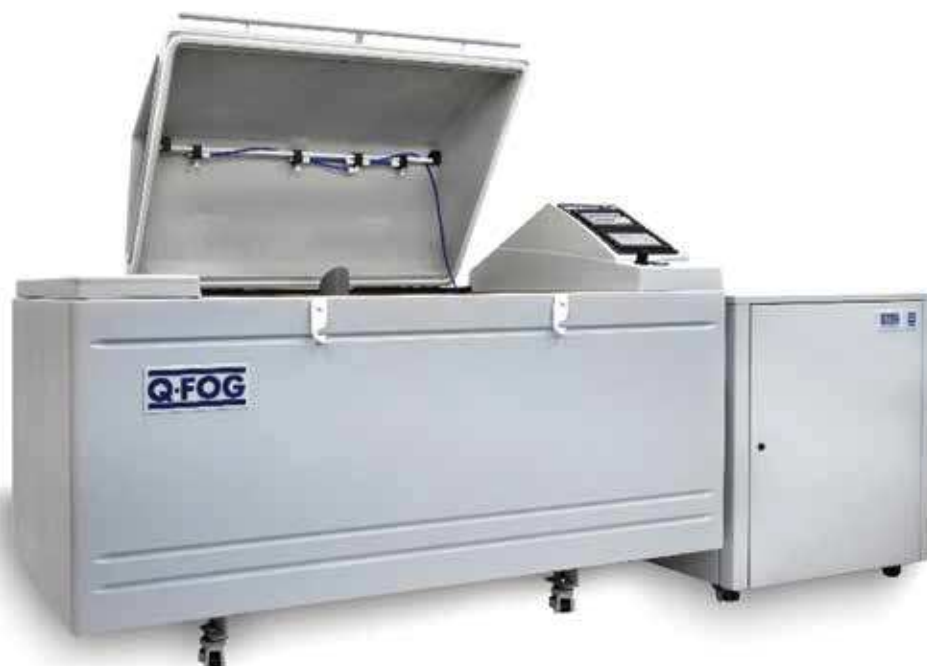
Obr. 1 – Korozní komora Q-FOG – model CRH s klimatizační jednotkou a systémem postřiku vzorů z víka komory
