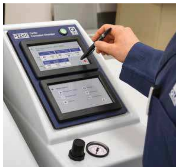
Obr. 2. – Ovládání korozních komor Q-FOG pomocí dvou barevných 7" dotykových displejů
