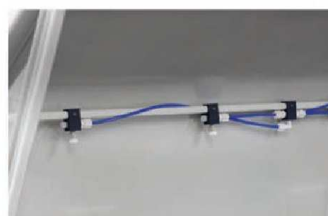
Výkyvná postřiková tyč s tryskami ve víku
